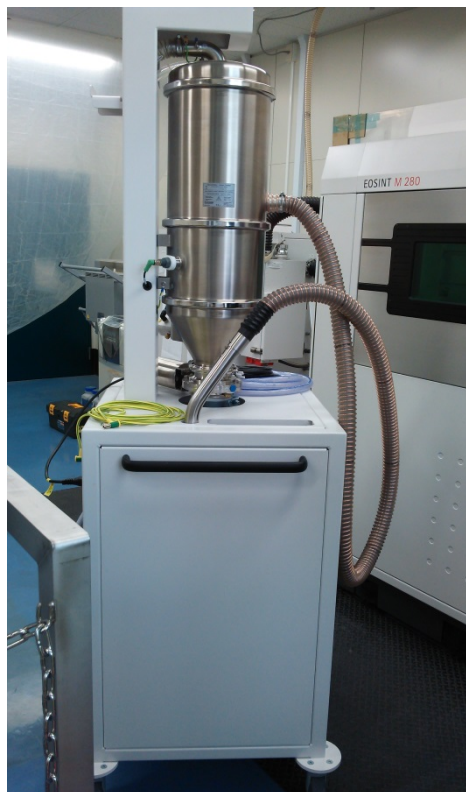
再利用する材料を吸引する装置 本装置で吸引し下部の缶へ投入する
