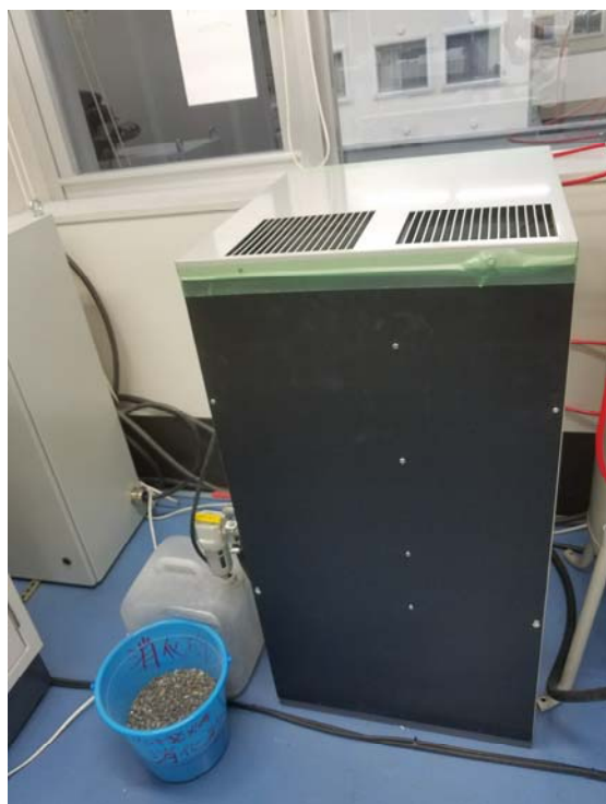
左側面（圧縮過程の水を排出するドレン）
