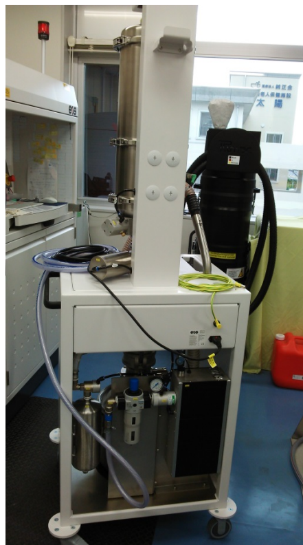
背面図：動力源はコンプレッサー
