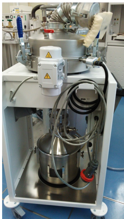
背面図：篩の動力源は手前の サーボモーター
