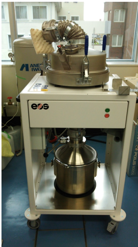
造形で使用しなかった材料を改修し スターを 再利用させる。
