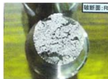
ダンベル (破断面)
