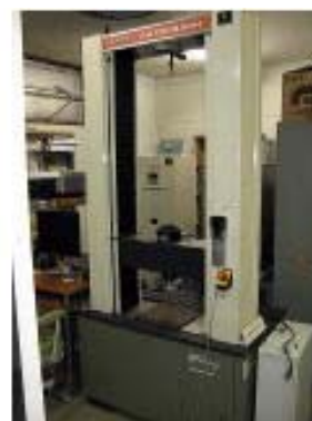
引張試験機 島津製作所 製 AG-10TB
