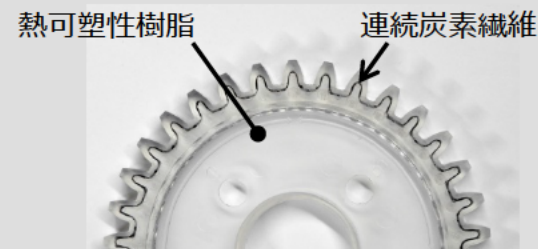
開発した金型システムで作製した炭素繊維強化歯車
