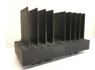
(開発工具の加工特性と精密加工されたカーボン電極)
