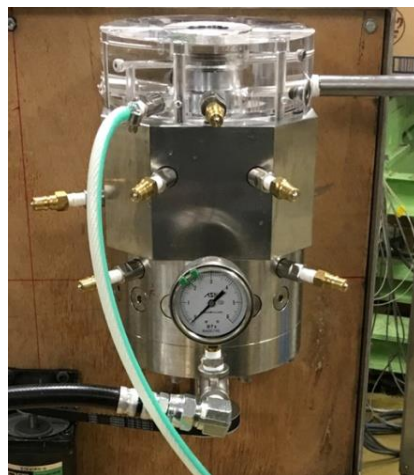
可視化用スラスト軸受モデルの写真
