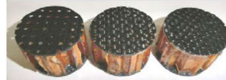
消音パネル吸音率測定試験片
