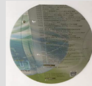
研削加工したSiCウエハ(4inch)
