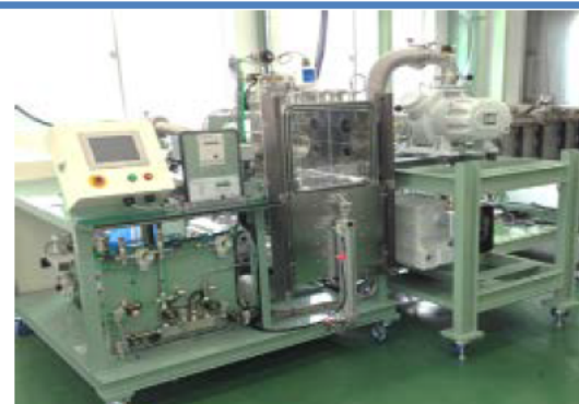
高圧液体を検査媒体とした漏れ検査装置
