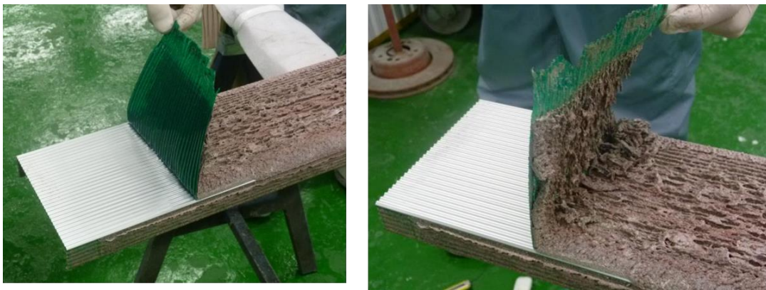
図 2-28 ストリップペイントの剥し作業の様子
