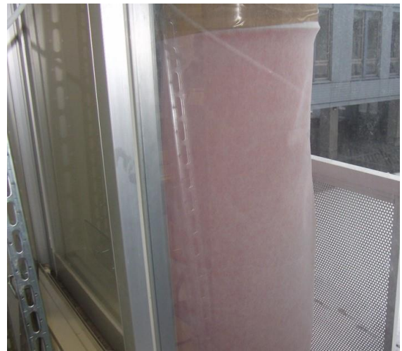
図 2-11 塗料ミスト・塵埃の捕集率測定の様子
