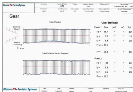
図 17. 歯車精度検査 (ギヤ)
