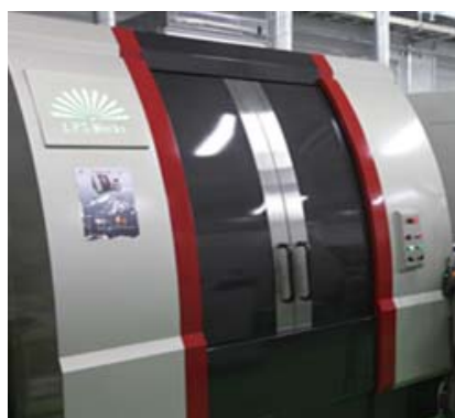
ピコ秒レーザー加工装置(左)と試作したマイクロ流路形状(右)
