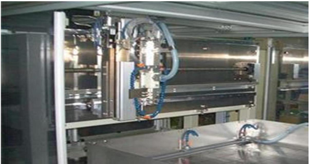
図1 開発したスモールツールラスタースキャン修正研磨装置
