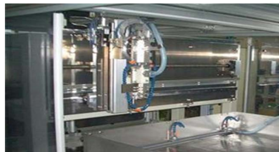
開発したスモールツールラスタースキャン修正研磨装置
