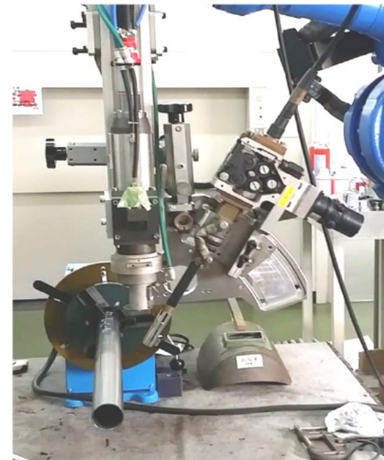
(レーザ・アーク複合溶接機)
