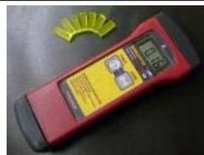
図 4. Ce:GAGG シンチレータ素子を搭載した放射線測定器。
