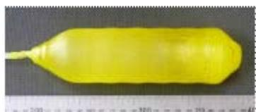
図 3. Cz 法で作製した 2 インチ径 Ce:GAGG シンチレータ結晶。
