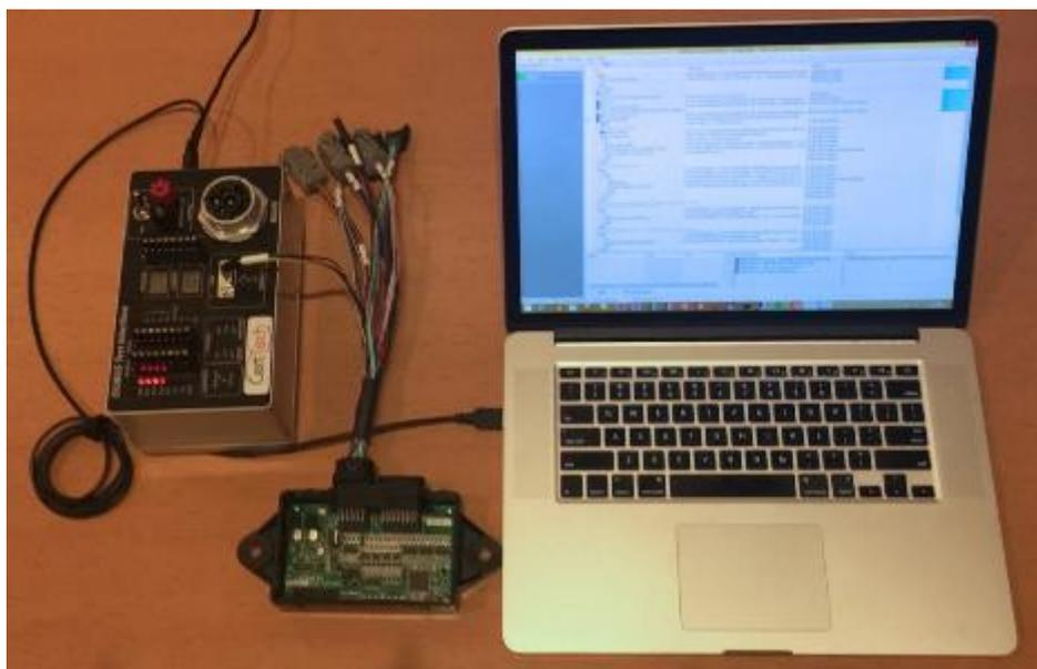
図 2-12 ISOBUS 適合試験機器用接続ユニットの動作確認
