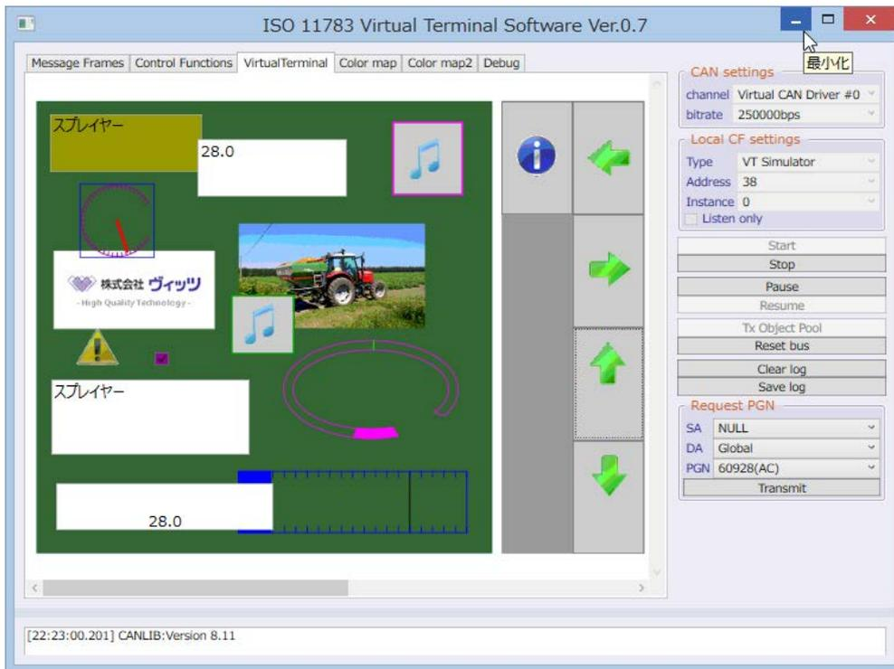
図 2-97 ISOBUS 通信動作確認ツール
