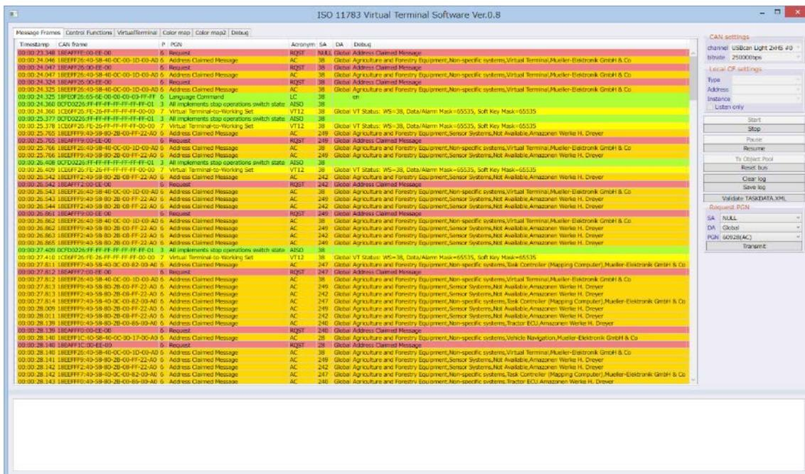
図 3-8 開発した動作確認用プロトコルアナライザツール
