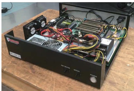
図 22 MAIN ユニット内部 (FPGA ボード)
