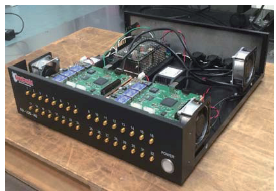
図 23 SUB ユニット内部 (A/D,D/A ボード)
