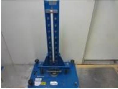
図 10：デュポン式耐衝撃試験機
