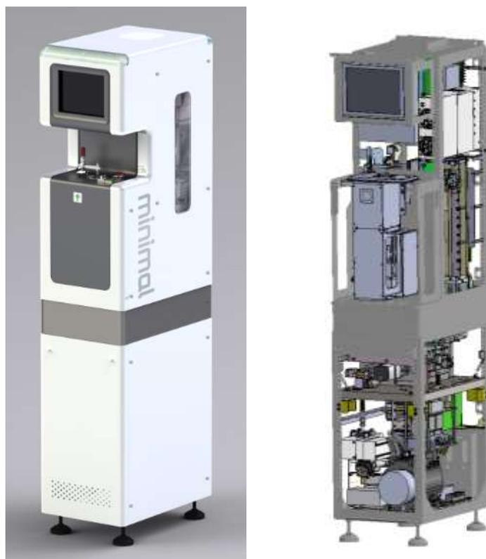
図1 超小型電子光学系基本体設計図の外観および内部構造
