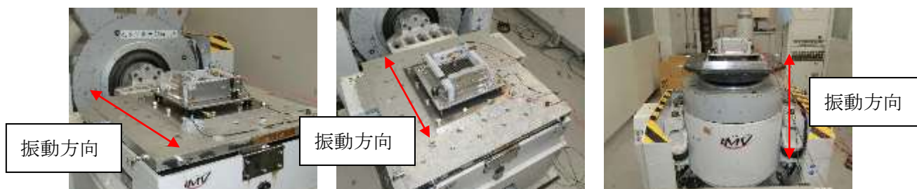
図-20 鉄道用モデル抵抗器振動試験(左：前後方向 中央：左右方向 右：上下方向)
