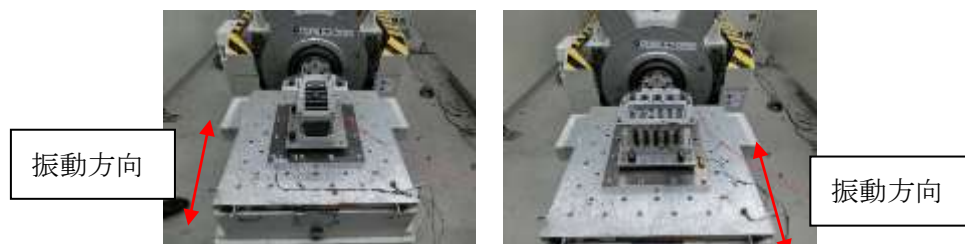
図-19 電力用モデル抵抗器震動試験状態(左：前後方向 右：左右方向)
