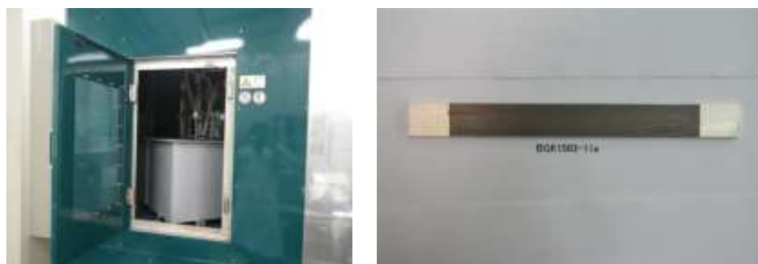
図-16 ナノめっき装置とメタセラ抗体(ナノめっき処理済)
