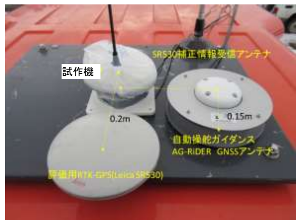
図 2-5.2 試作機と精度評価用 RTK-GPS のアンテナ設置状況
