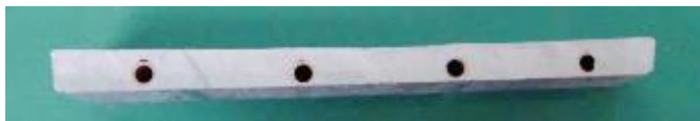
図 2-7 試作した銅パイプ鑄込みアルミ板の断面の様子
