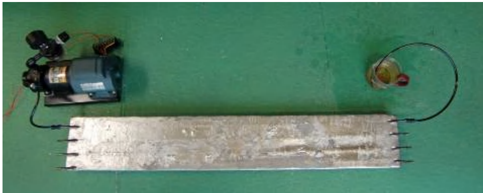
図 2-6 銅パイプ鑄込みアルミ板について銅パイプの通気性を検査している様子 銅パイプに空気を流し、反対側からパイプを水中に流して泡の発生状態で通気性を確 認した。
