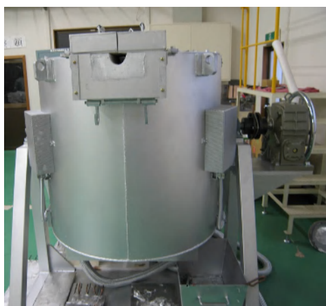
図 2-2 アルミ溶解炉の外観。 処理量： 50kg
