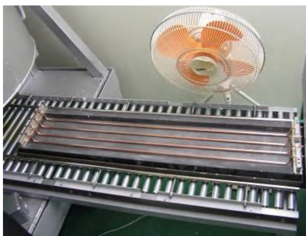
図 2-4 大型カーボン鋳型に銅パイプをセットした様子。 ここにアルミ溶湯を注入し、直ちに急速空冷する。
