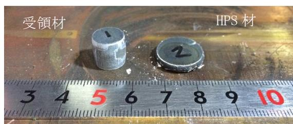
図④-3 圧縮試験後の試料の違い
