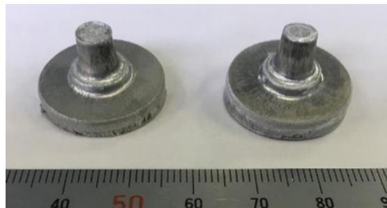
図④-10 A1050 純アルミニウムで仕打ちしたウェストゲートバルブ
