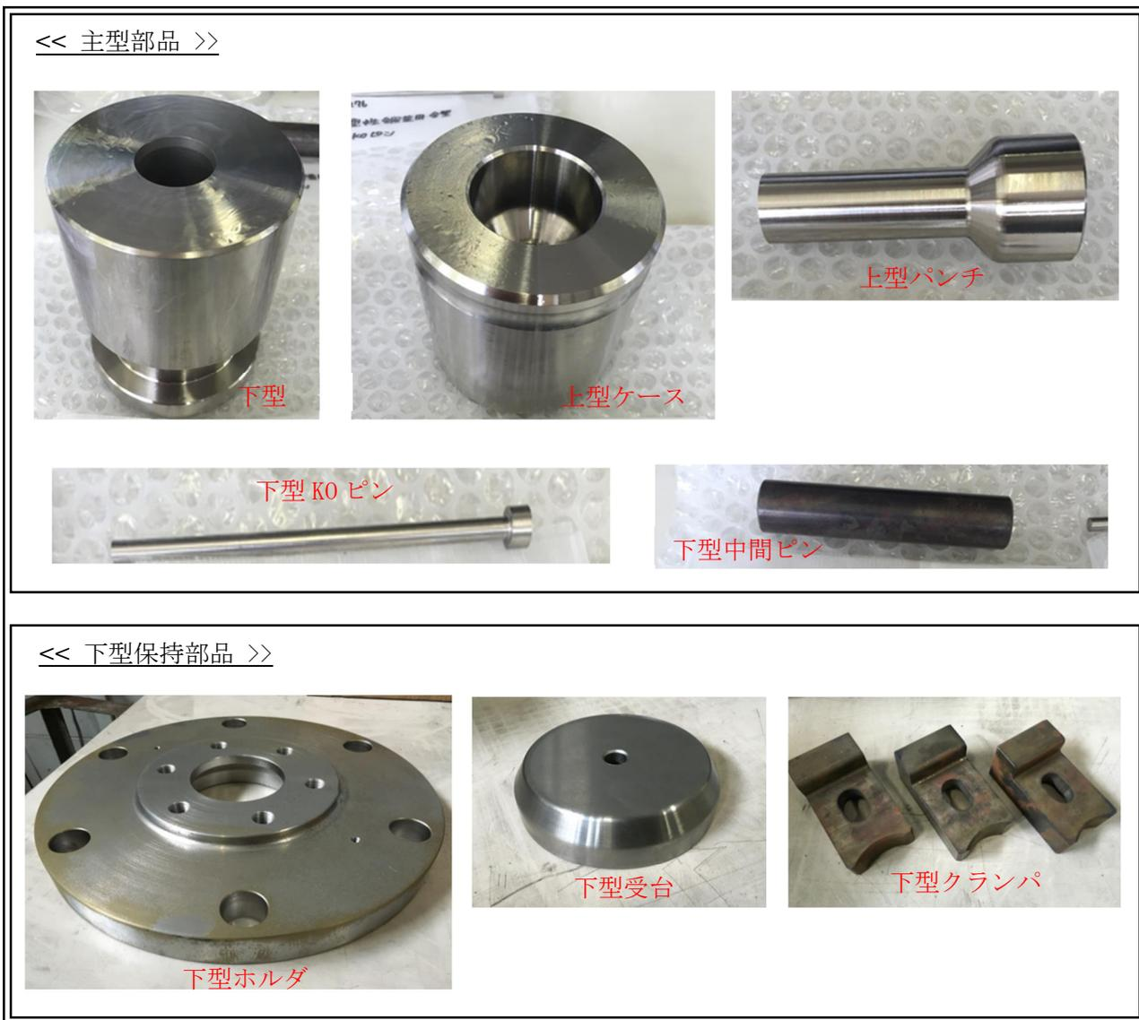
図②-2-7 超塑性鍛造用金型
