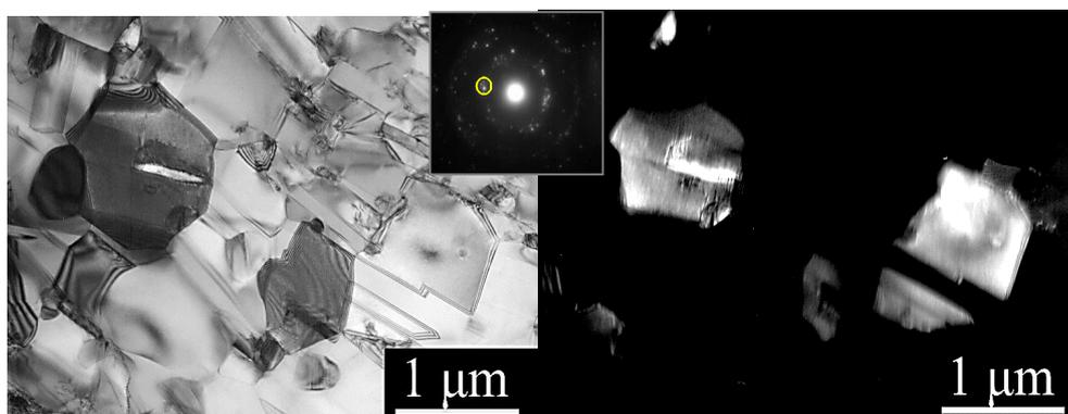
図③-22 HPS 加工試料を 900°C で 1 時間保持したときの TEM 観察
