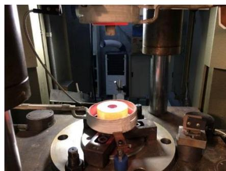
図④-11 加熱した超塑性鍛造
