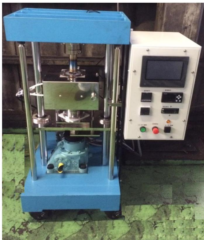
図①-1-1 高温鍛造性評価試験機
