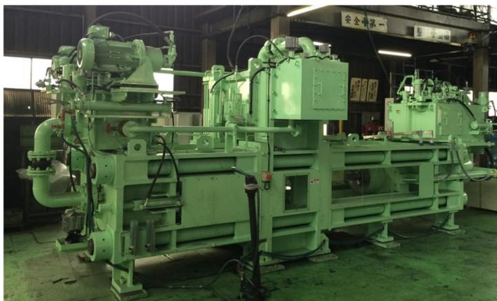
図⑤-1 開発した強加工試験装置 (HPS 装置)
