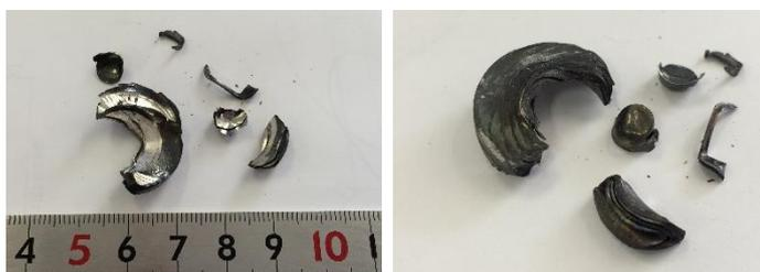
図④-14 取り出した超塑性鍛造試料の表と裏
