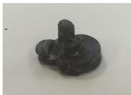
図④-15 超塑性鍛造後の試料
