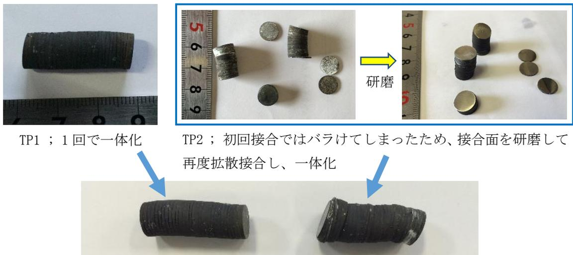
図④-8 拡散接合した組織改質材
