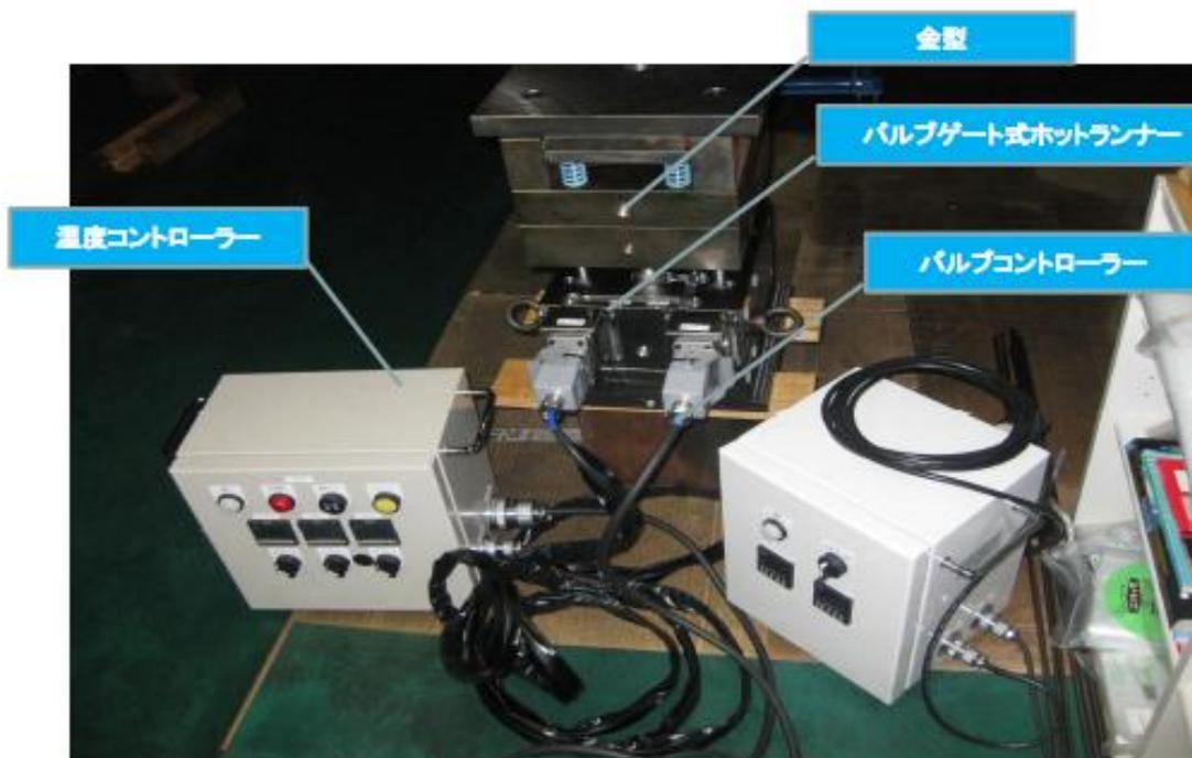
図2-3-4 テストピース金型及びホットランナー
