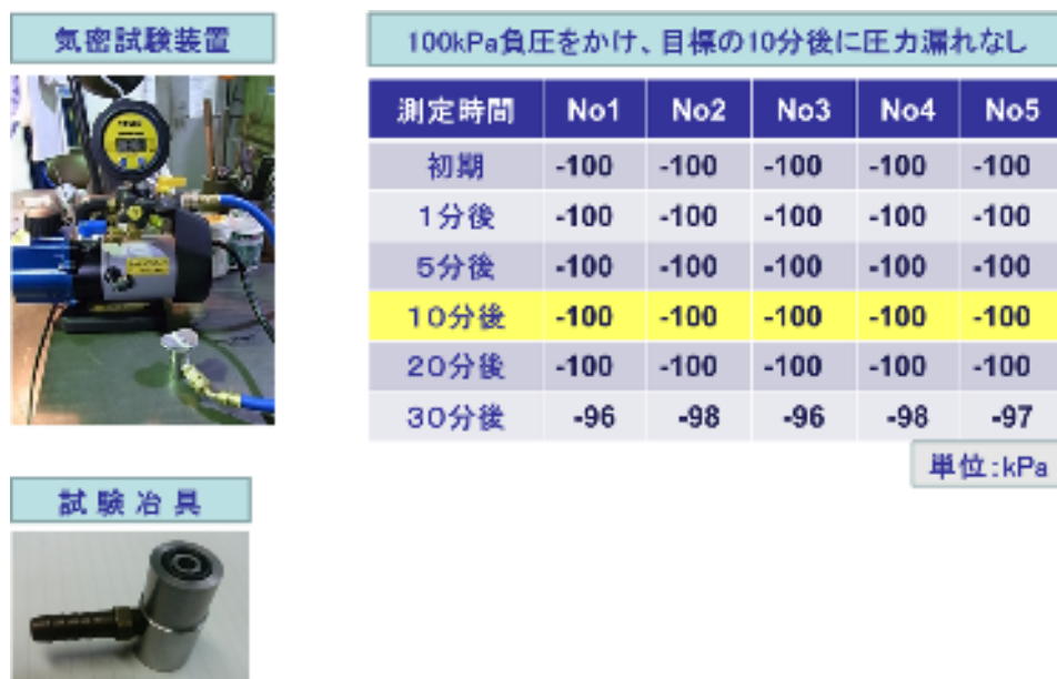
図 2-4.9 気密性試験結果
