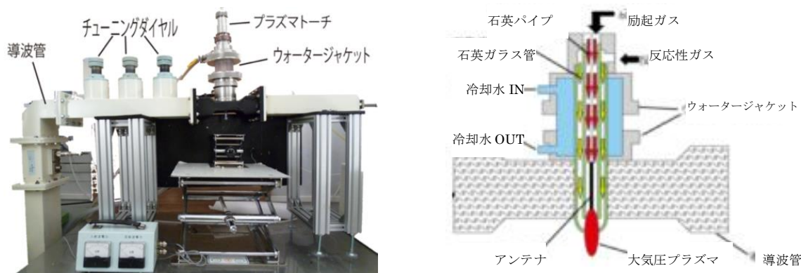
図2.4.2.2 大気圧プラズマトーチの外観と構造
