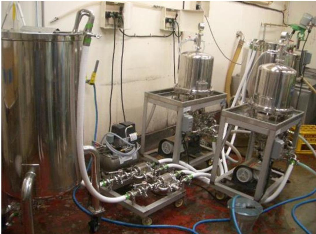
図2-1-1 フィルターろ過装置（右）および溜液タンク（左）
