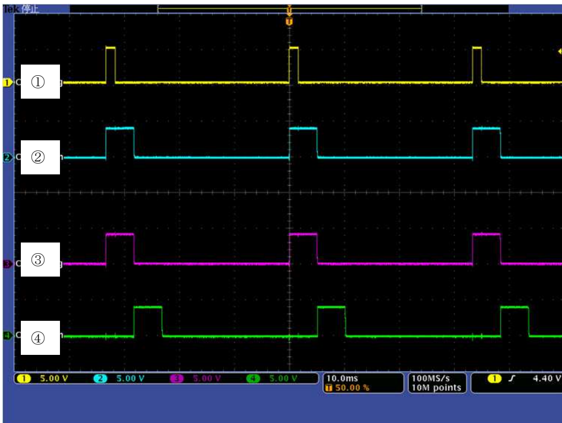
図 2-2-2-3 各部の信号波形 (横軸のフルスケールが 100msec , 縦軸の 1 目盛りが 1V)
