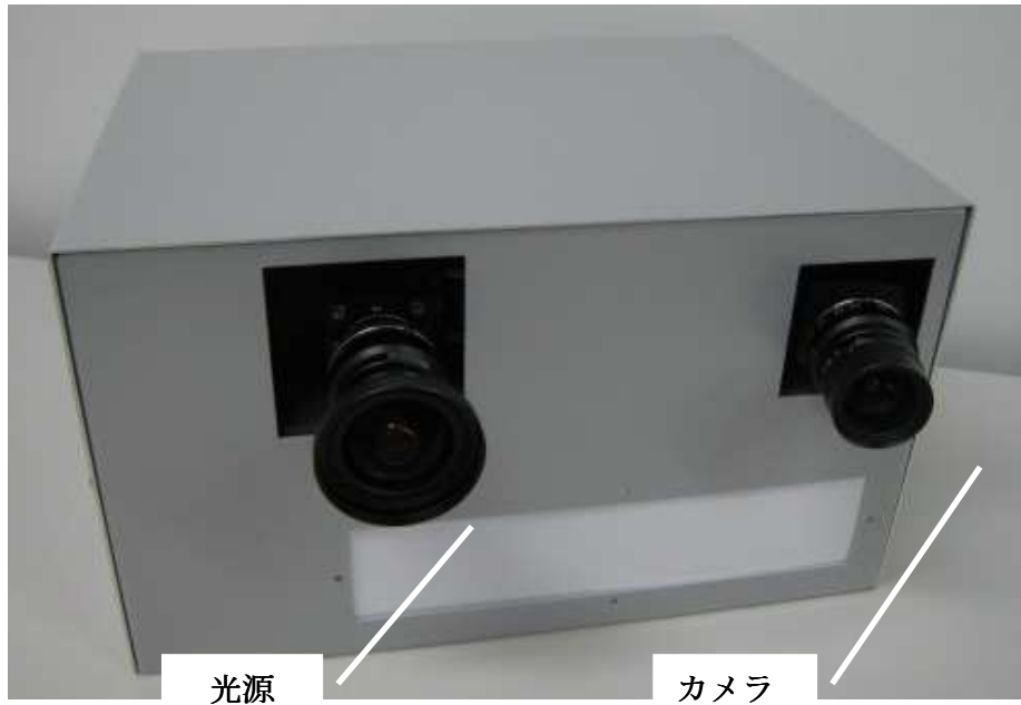
図 2-5-1-2 作製した侵入検知システム
