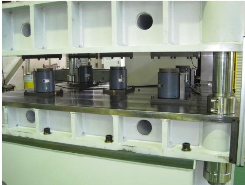
図2 可動テーブル内の測定センサ
