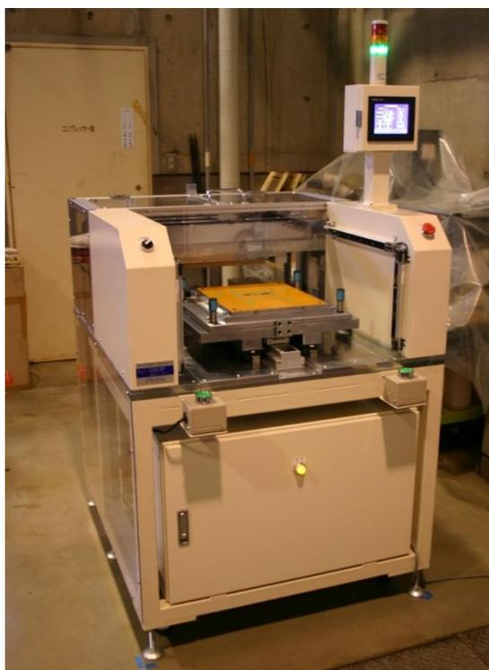
図3 実証実験用プレス機構及び金型ダイセット一式
