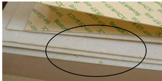
図5 使用を検討した発泡ウレタン（丸印は、発泡ウレタンの表面の貫通穴を示す）
