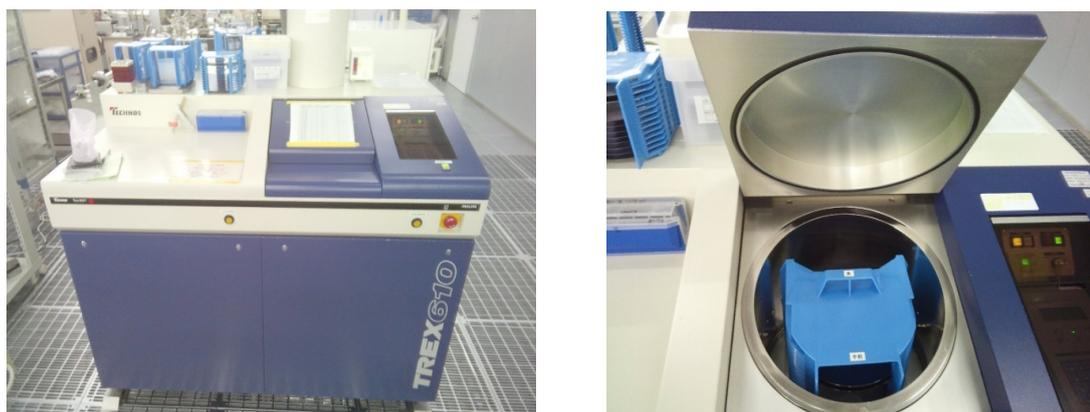
図7 全反射蛍光X線分析装置（大阪大学）
