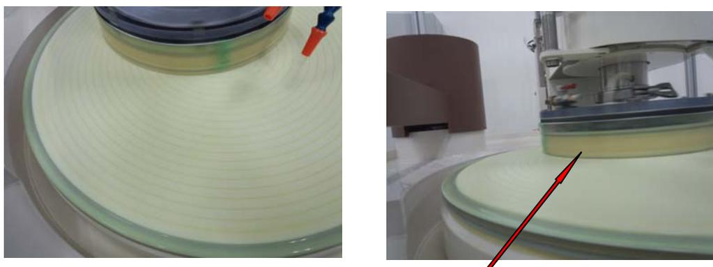
CMP 研磨装置での実験状況、リングの内部に研磨液が保持されている。
