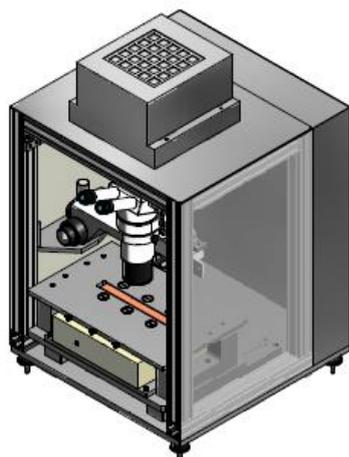
(熱切断実験装置設計・製作)
