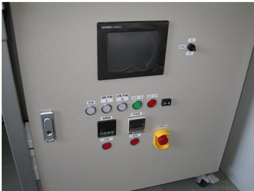
【熱切断実験装置：制御盤】
