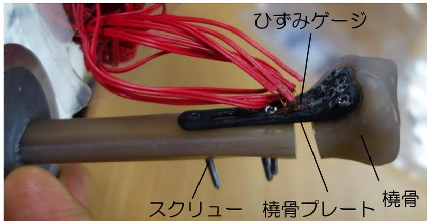
図 2-4 検証試験用橈骨－橈骨プレート系試験片
