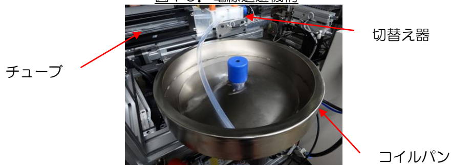
図10. 電線退避機構
