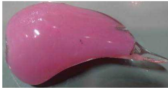
図 2-2-3 胆嚢モデルの二色成形結果
