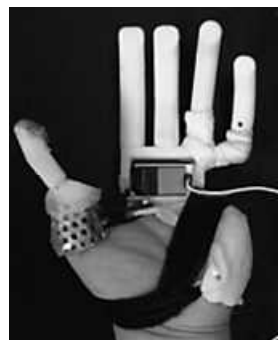
(a) 手部用義手のリンクメカニズム
