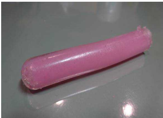
図 2－2－2 血管モデルの二色成形結果
