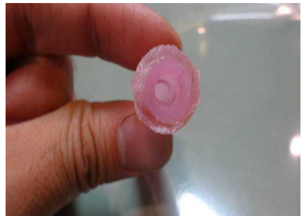
図 2－2－2 血管モデルの二色成形結果
