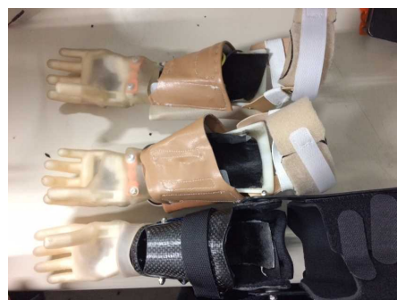
Fig. X42 導電性高分子を用いたソケットと cFRP を用いたソケット
