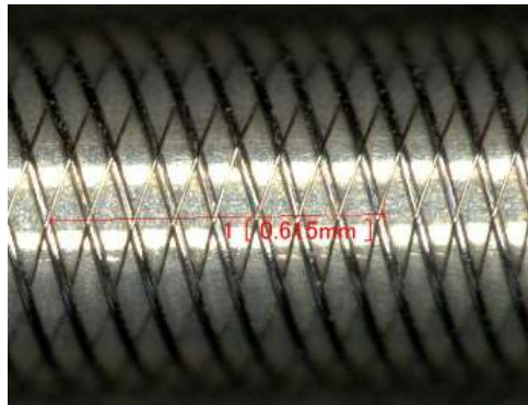
図3 タングステン極細丸線と太径丸線の組み合わせ編組
