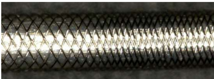
図6 作製した連続テーパー線に編組線を可変ピッチで編組加工
