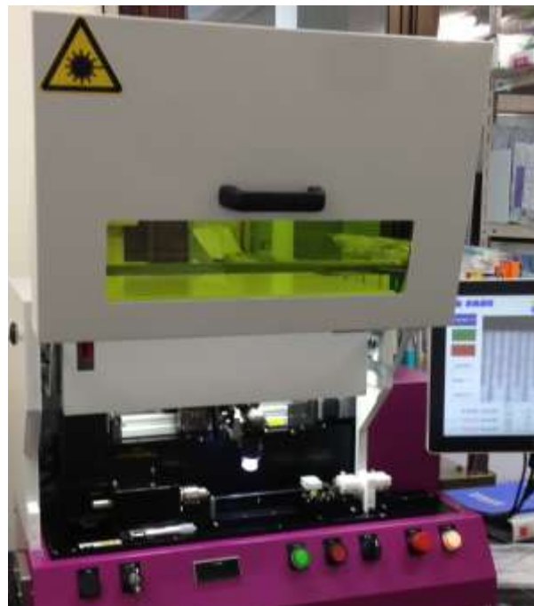
図9 樹脂レーザー溶着装置
