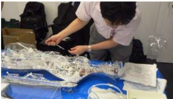
図11 臨床医（大阪医科大学宮地先生）による血管シミュレーターでの製品評価
