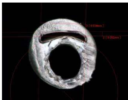
図7 円弧型サブルーメンを持つ編組チューブ試作（サブルーメン潰れ）
