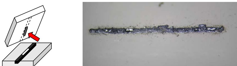
図 2-4-3 カバーガラス基板に付着したガラスパウダ（合わせ面を観察）
