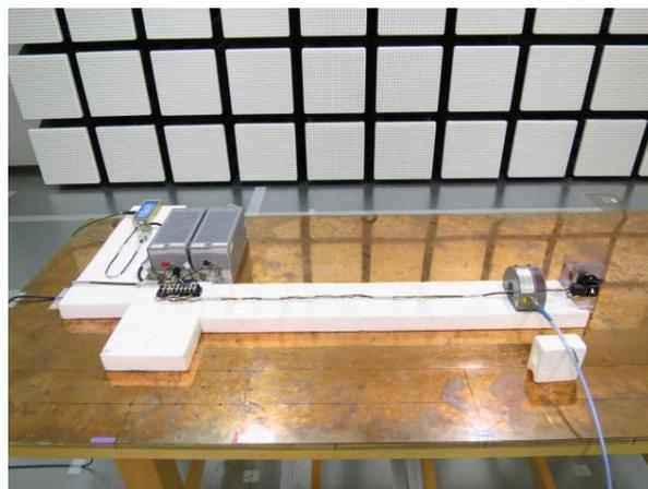
ケーブルに電流ノイズを印加してセンサー動作の影響を試験する。（電流ノイズ：60 mA）
