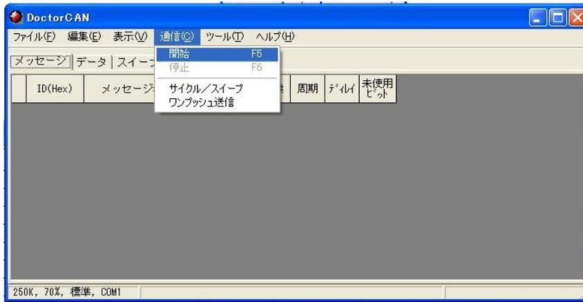
図 16. CAN通信モニタ装置 (Simple-CAN2) のCAN通信測定開始
