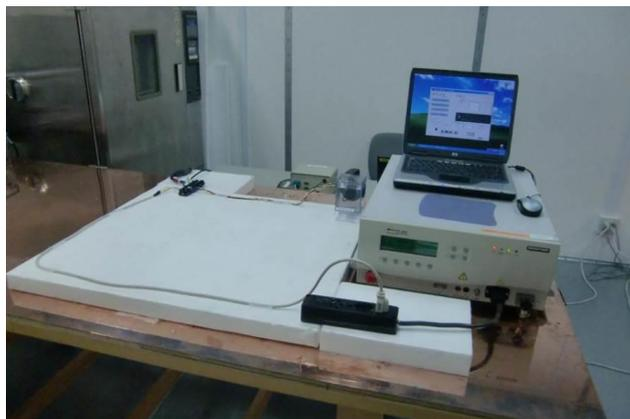
センサーに雷サージを印加してセンサー動作の影響を試験する。（雷サージ電圧：最大±2kV）
