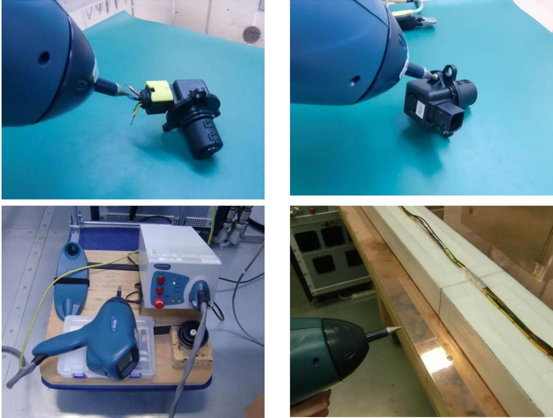
センサーに静電気を印加してセンサー動作の影響を試験する。(静電気電圧：最大±15kV)
