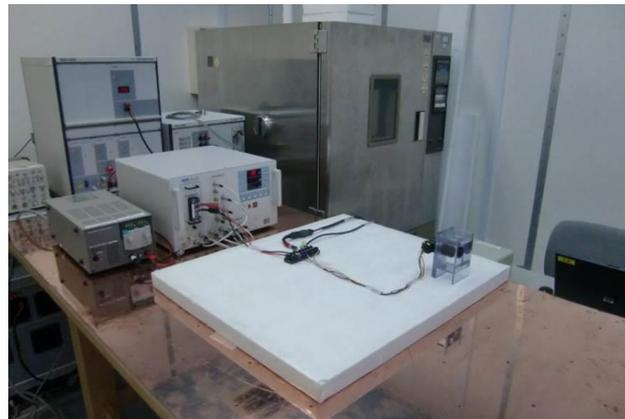
センサーに電源ノイズを印加してセンサー動作の影響を試験する。（電源ノイズ電圧：最大±1kV）
