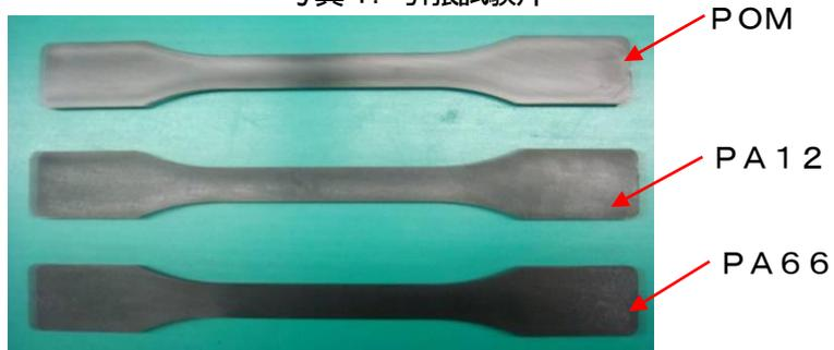
写真5. 引張試験片燃料浸漬試験
