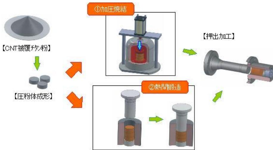
図 1 1 製造工程における加圧焼結、及び熱間鍛造の実施時期
