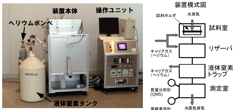
図 2-1-1 水蒸気バリア性評価装置の外観と模式図
