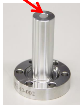
図2-1-1 標準コンダクタンスエレメント (SCE) とのその原理
