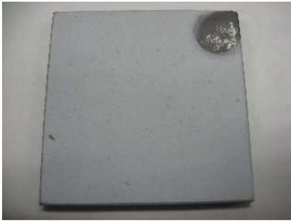
図4 溶射後テストピース表面
