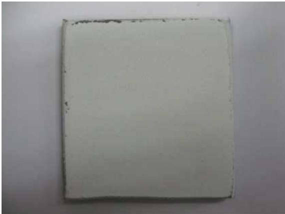
図7 テーブル搬送方式によるアルミナ微粒子 (粒径 1.2  $\mu\text{m}$ ) 溶射後テストピース外観
