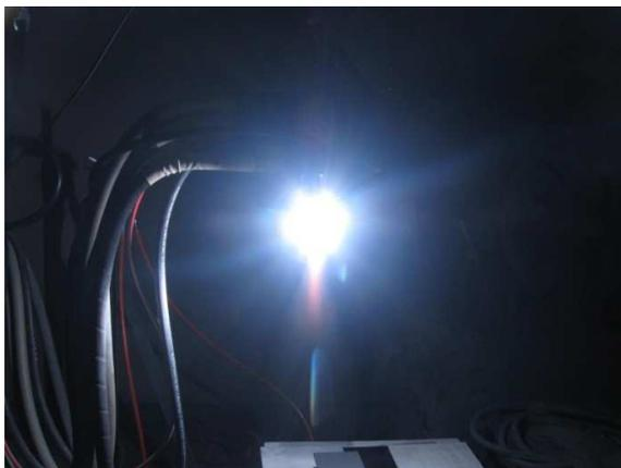
(a) 溶射ガン点火→粉末供給開始時
