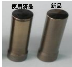
新品と使用済み 品パンチピンの 計測
