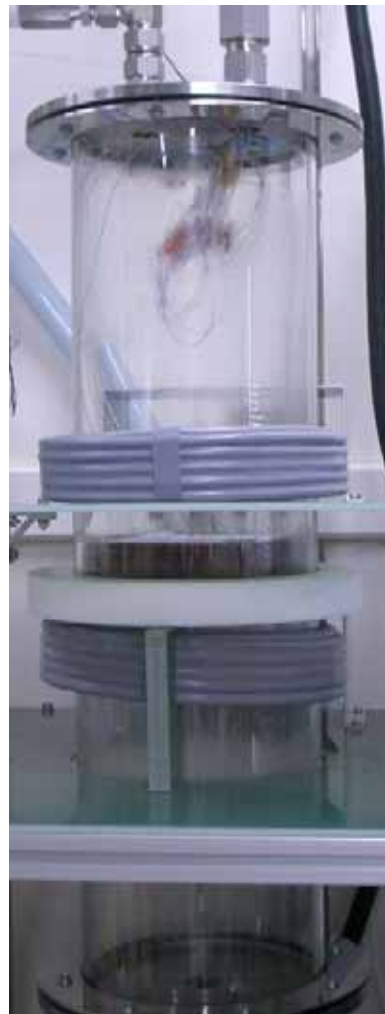
図 2-1-13 脱離時の結露状況
