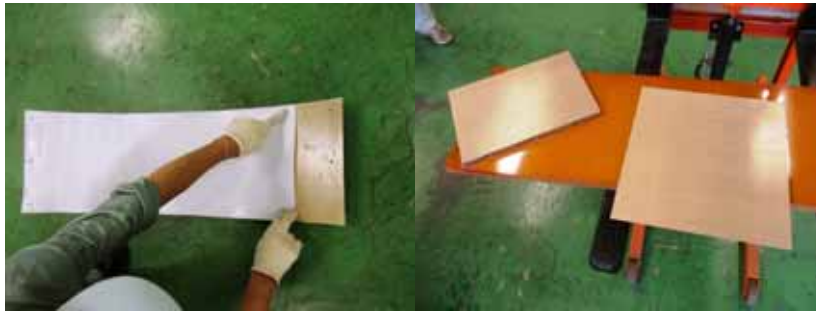
図 2-2-5 ハニカム押え板へのテフロンシート貼付け作業
