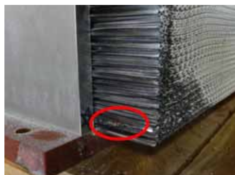
図 2-2-4 火花放電様事象発生箇所の八ニカム
