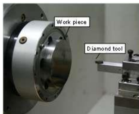
図 4.2 超精密切削加工機の概観
