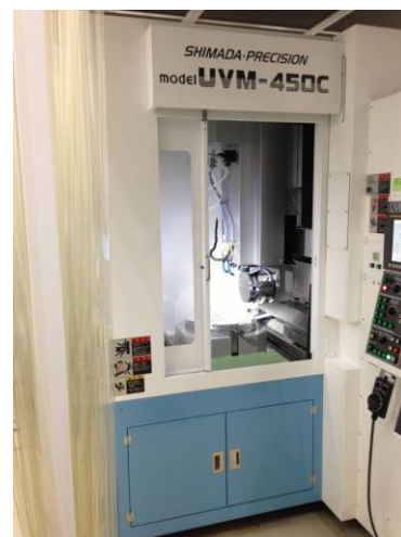
図 5.1 フレネルレンズ用超精密立形加工機
