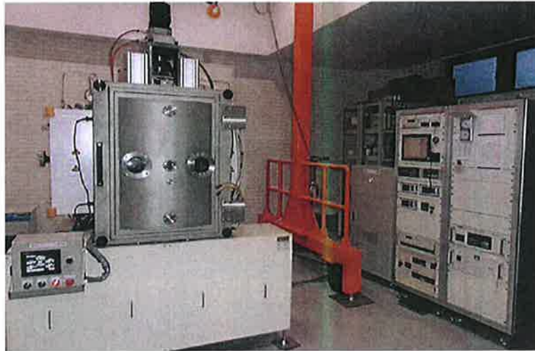
図 2-3 RTR 縦型搬送連続スパッタ装置全景
