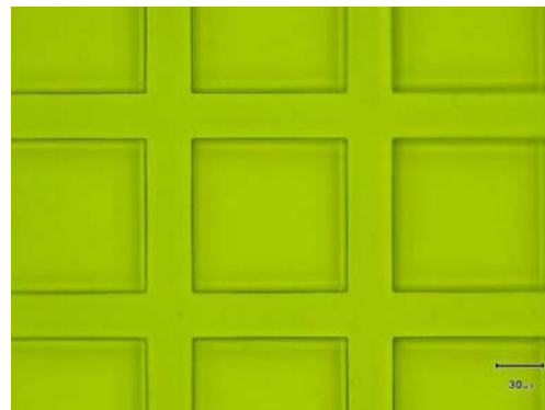
テストパターン L/S=30/100 μm
