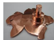
Φ4ボス高さ:6.6mm (狙い:6.1mm) Φ8.5高さ:4.5mm (狙い:4.2mm)
