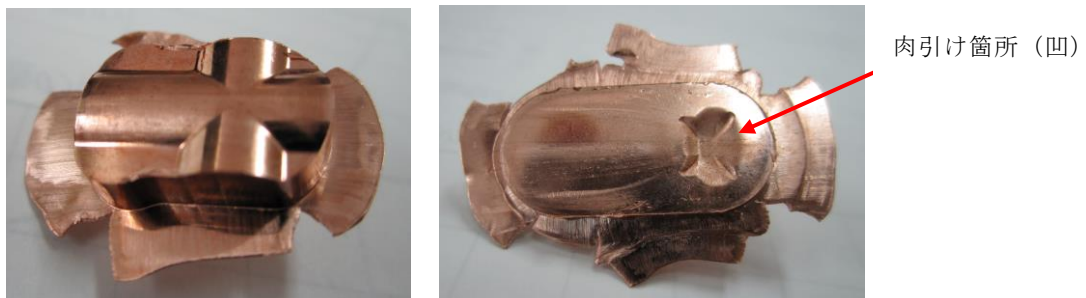
写真 2.13 肉引け対策金型によるボス部予備成形と 2 段ボス成形加工結果
