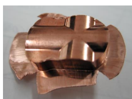
写真 2.4 肉引け対策金型によるボス部予備成形加工結果
