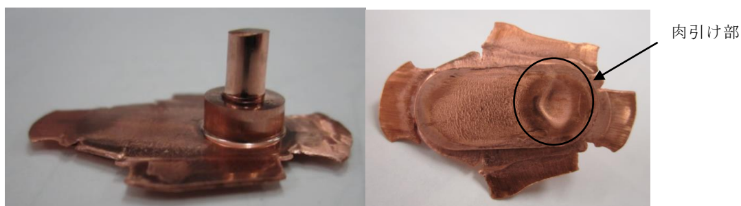
写真 2.12 2 段ボス成形後の肉引け
