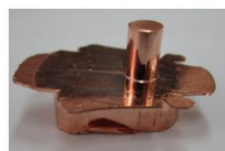
Φ4ボス高さ:6.4mm (狙い:6.1mm) ベース部厚み:5.5mm (狙い:4.8mm)
