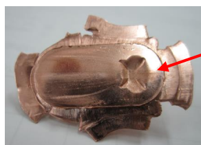
写真 2.5 肉引け対策形状による 2 段ボス成形加工結果
