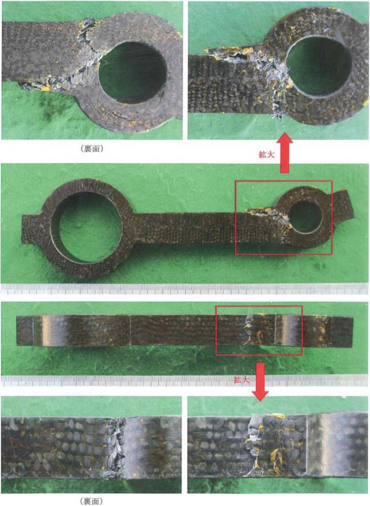
図9 圧縮試験での破損状況
