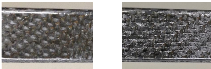
図2-4-1 成形品の縦壁部表面観察（左：加圧有り、右：加圧無し）
