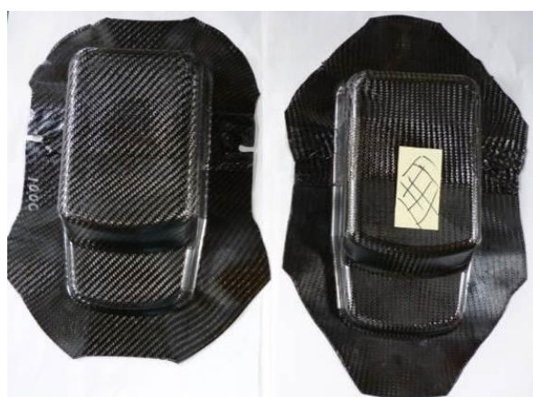
図2-2-3 繊維方向の違いによる成形品の外観比較 (左: 0/90、右-45/45)
