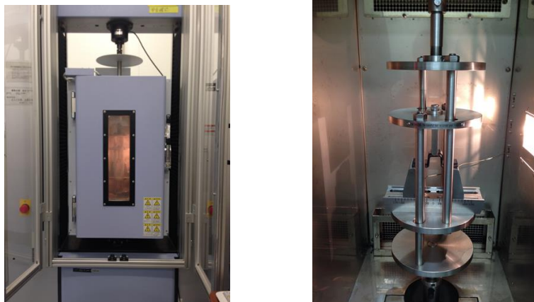
図2-5-3 恒温槽付き材料試験機による強度試験
