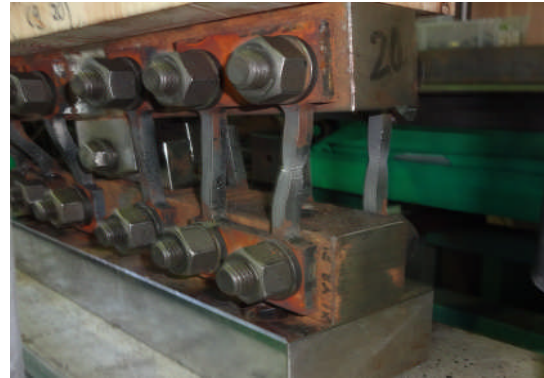
図 2.4.12 変形金物の変形状況
