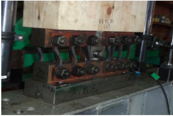
図 2.4.12 変形金物の変形状況
