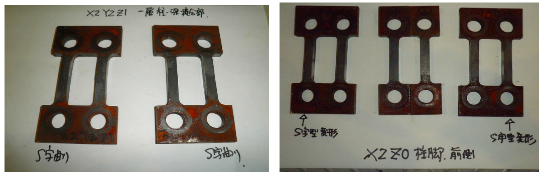
図 2.5.7 金物の変形状況
