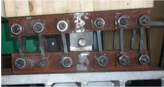
図 3.1 変形金物と締結ユニット (試験後)
