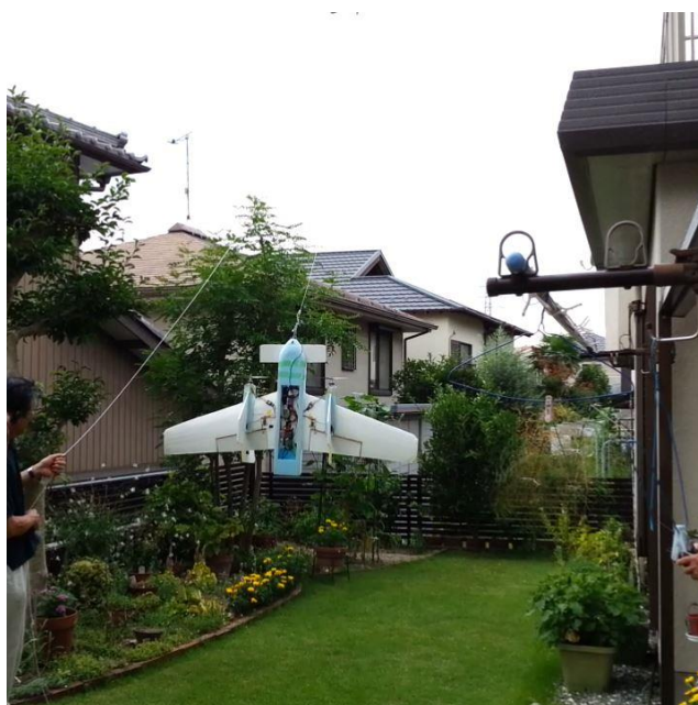
図 2-1-5-5 屋外紐釣り試験状況
