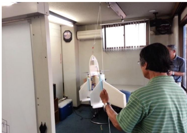
図 2-1-5-4 室内紐釣り試験状況
