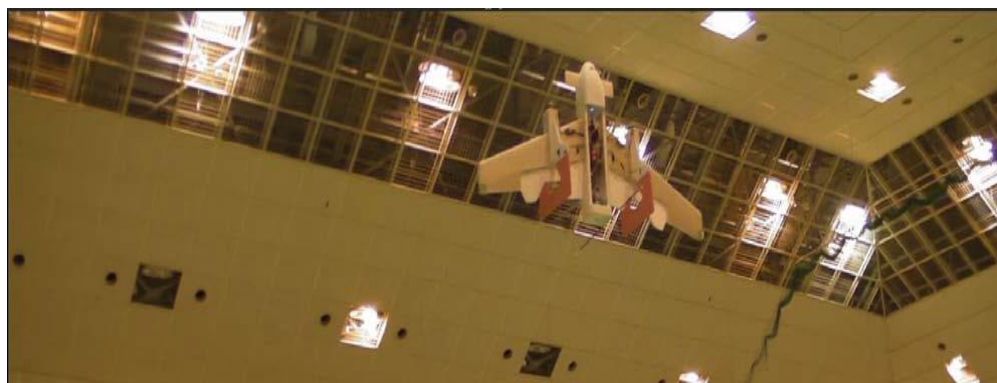
図 2-1-6-4 ホバリング試験機試験状況-高度 5m
