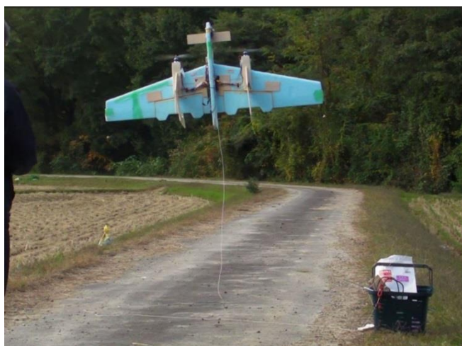
図 2-1-5-6 屋外紐付き試験状況
