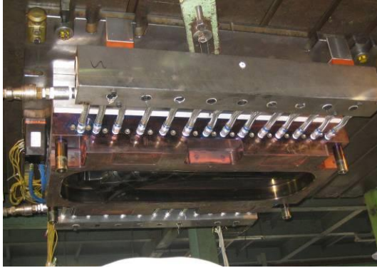
図 2-1-1-11 ブレード用金型 改造前
