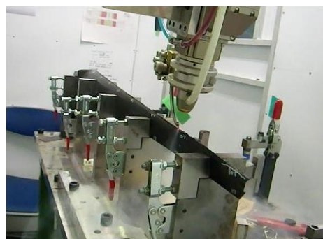
図 2-2-2-2 レーザー溶接状況
